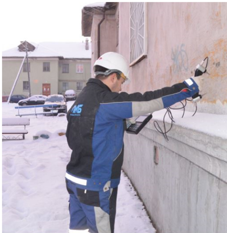
Рис. 4 – Определение прочности штукатурного слоя фасада в осях 5/1
