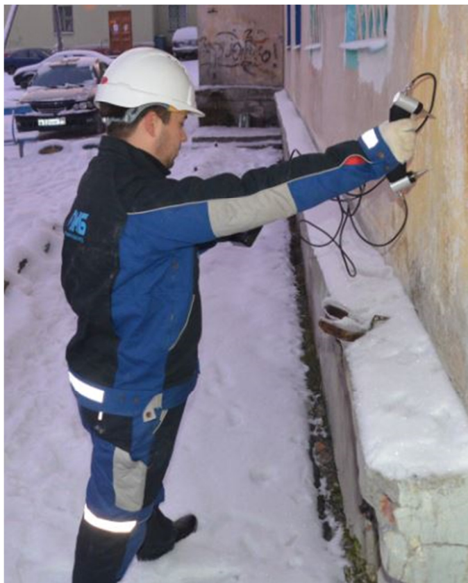
Рис. 6 – Определение прочности штукатурного слоя фасада в осях 5/1
