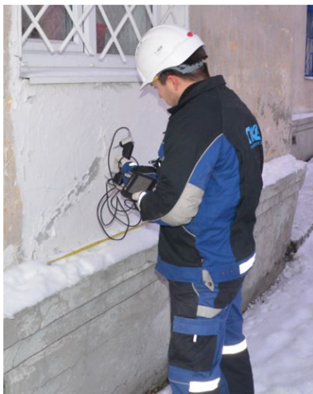
Рис. 7 – Определение прочности штукатурного слоя фасада в осях 5/1
