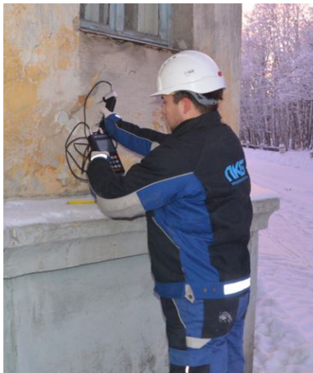
Рис. 10 – Определение прочности штукатурного слоя фасада в осях 1/5
