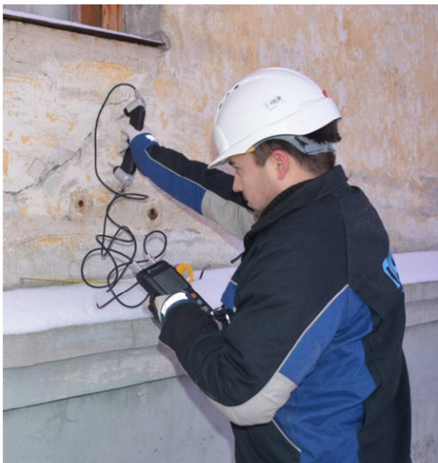
Рис. 11 – Определение прочности штукатурного слоя фасада в осях Ж/А
