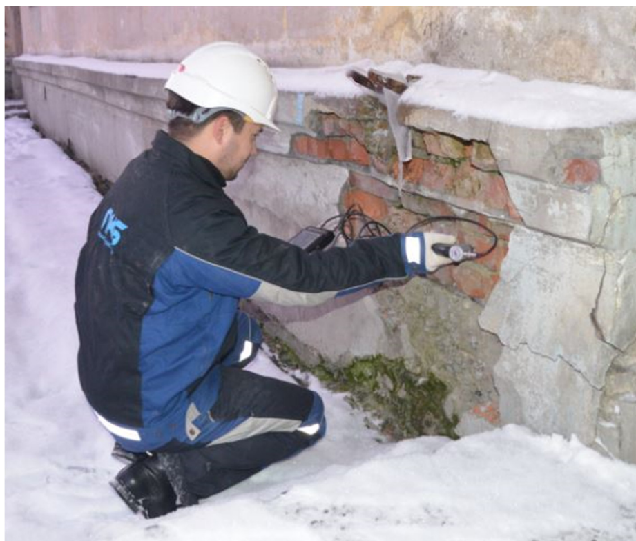
Рис. 5 – Определение прочности кирпичной кладки фасада в осях 5/1
