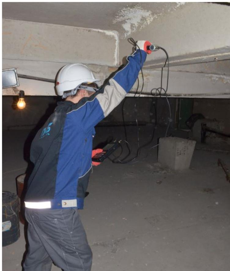
Рис. 10 – Определение прочности бетона ребра плиты покрытия
