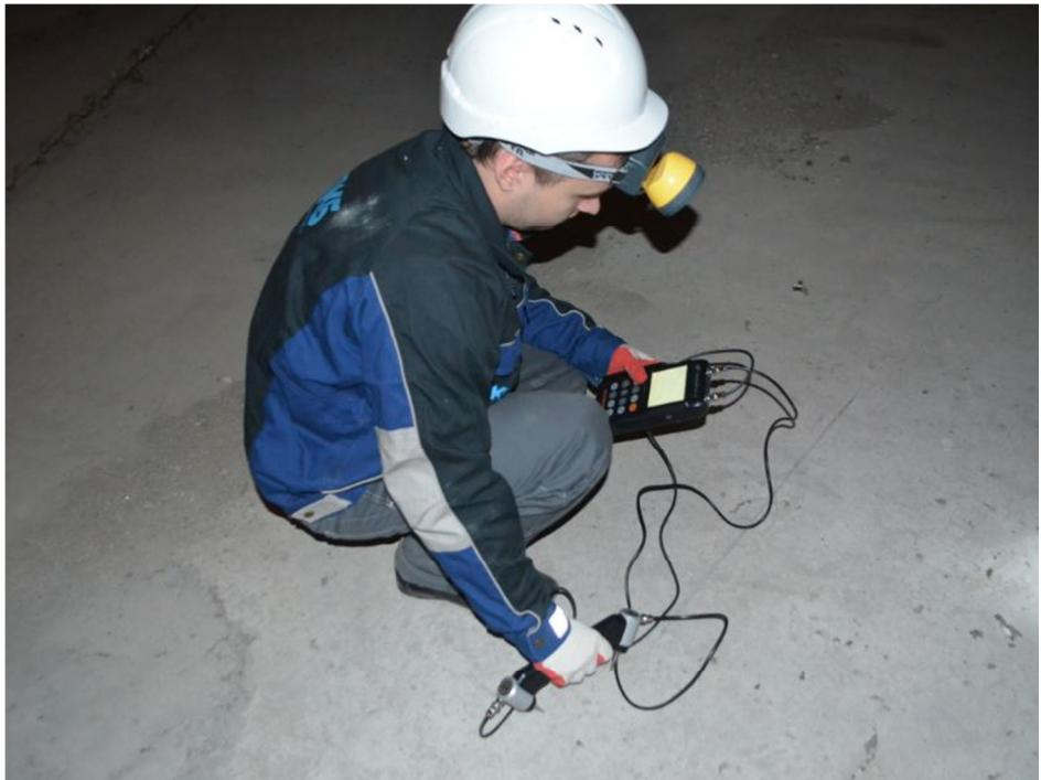
Рис. 12 – Определение прочности бетона плиты чердачного перекрытия
