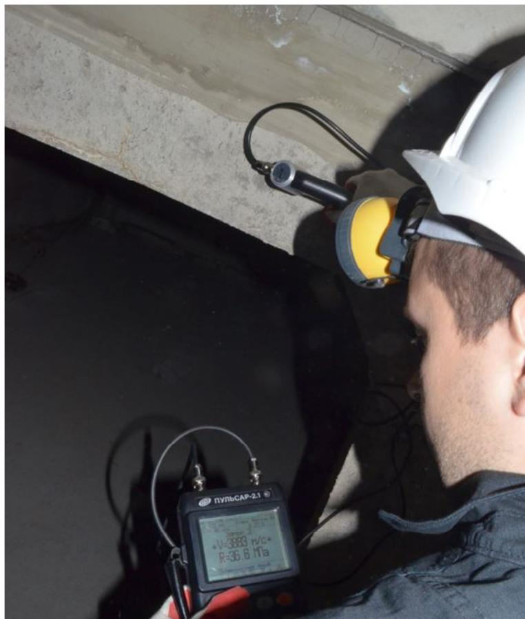
Рис. 8 – Определение прочности бетона стойки чердака СЧ-2
