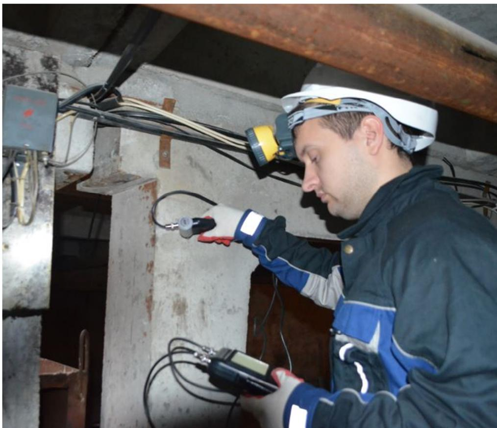
Рис. 13 – Определение прочности бетона стойки чердака СЧ-3
