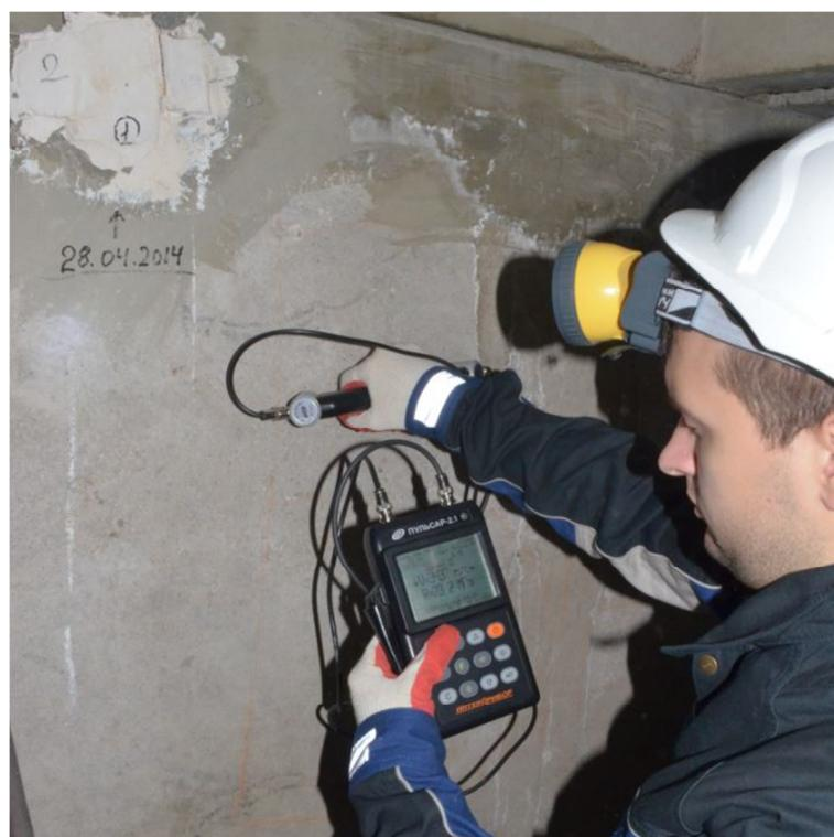
Рис. 7 – Определение прочности бетона парапетной стеновой панели
