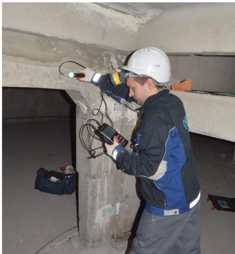
Рис. 9 – Определение прочности бетона стойки чердака СЧ-2
