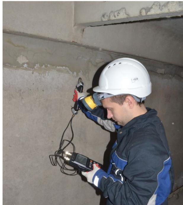
Рис. 6 – Определение прочности бетона парапетной стеновой панели
